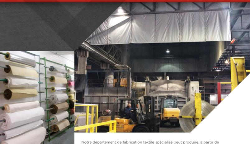
différents matériels et sous différentes formes, câbles, rubans, gaines et tissus à partir de fibres telles que la fibre de verre, la céramique ou les fibres aramides. Nous pouvons enduire, traiter en surface ou encore laminer certains produits pour augmenter les possibilités de répondre aux besoins de notre clientèle. Finalement, nous faisons la coupe à la main, à l'aide d'emporte-pièces ou au jet d'eau, et l'assemblage, dans notre département de couture industrielle.
