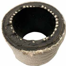
Boyau avec billes de céramique revouvert de fibre de verre
